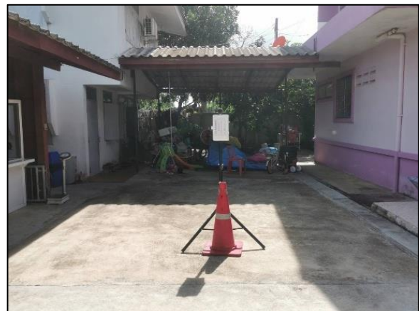
ตัวอย่างการติดตั้งสถานีตรวจวัดระดับเสียงและความสั่นสะเทือน
